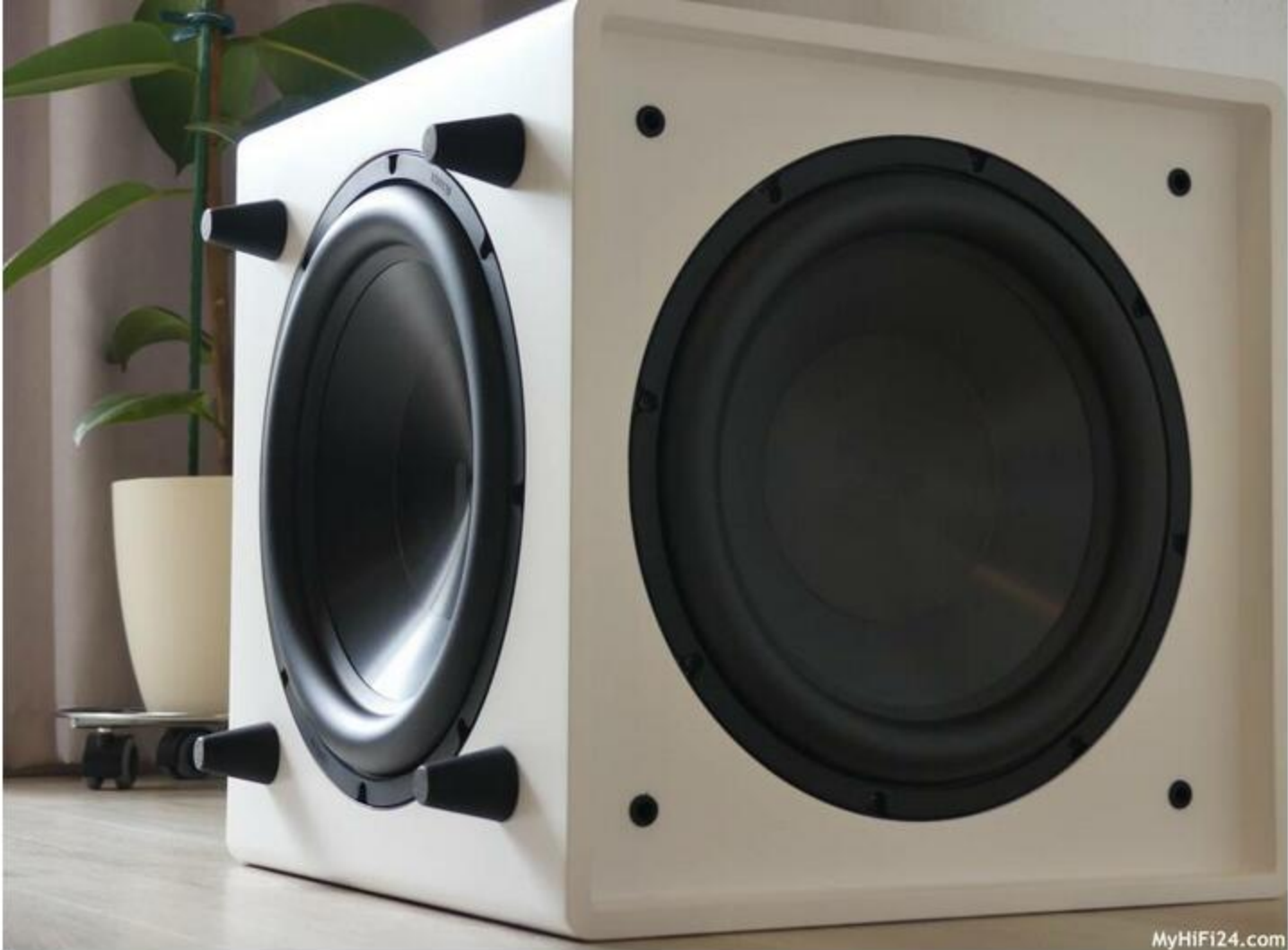
Links im Bild die Aktivmembran und rechts die Passivmembran (Foto: Schmidt P.)
