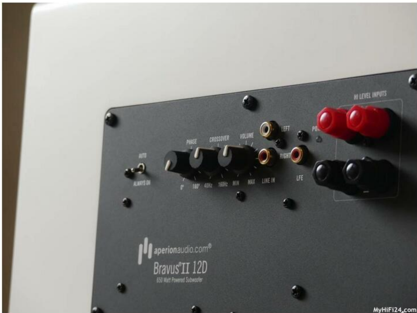
Einstellungsmöglichkeiten an der Endstufe auf der Rückseite vom Subwoofer (Foto: Schmidt P.)
